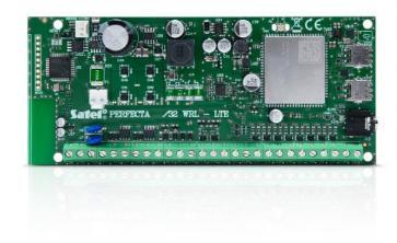
cartes nano-SIM pour assurer une communication ininterrompue: si la communication avec le réseau du premier opérateur échoue, la deuxième carte est automatiquement sélectionnée.
